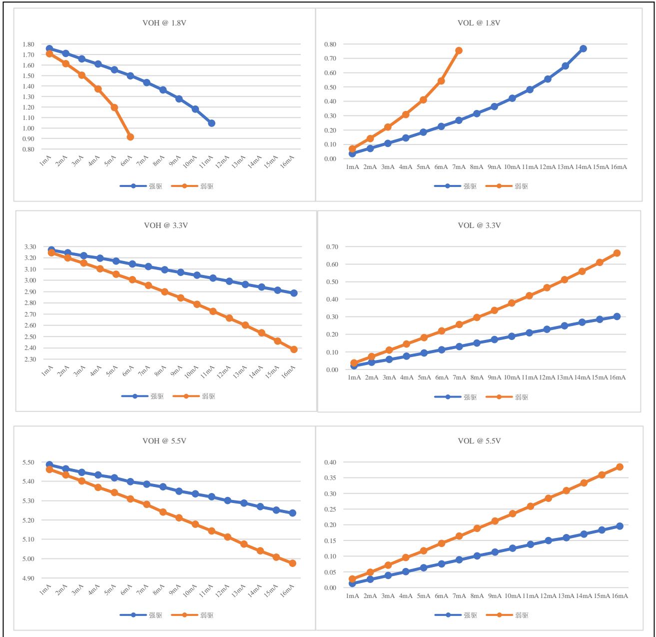
图 7-2 输出端口 VOH/VOL 实测曲线
